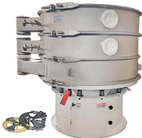
Легкая настройка траектории движения продукта по ситам
